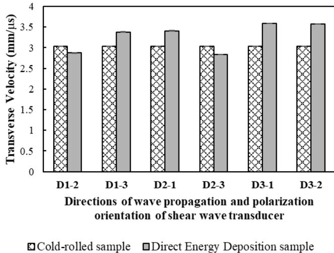
**FIGURE 2:** TRANSVERSE VELOCITY OF THE INCONEL SAMPLES
