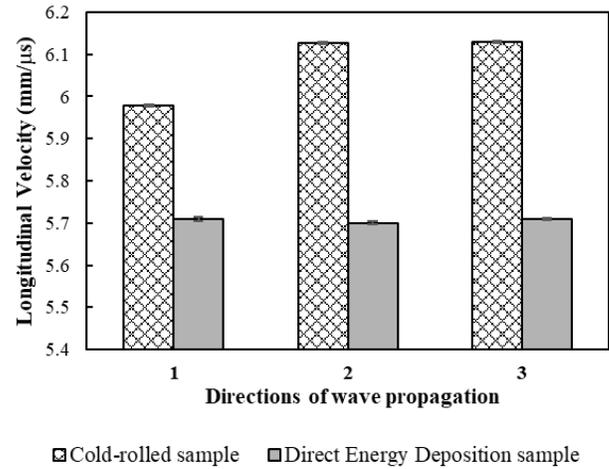
**FIGURE 1:** LONGITUDINAL VELOCITY OF THE STAINLESS STEEL SAMPLES
