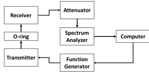
**FIGURE 1: BLOCK DIAGRAM OF THE ULTRASONIC SYSTEM CONFIGURATION.**
