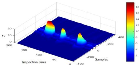
**FIGURE 4:** A) C-SCAN OF THE FATIGUE CRACKS INSPECTION.
