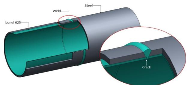
**FIGURE 1: CLAD PIPE WITH THE INSPECTION REGION HIGHLIGHTED.**
