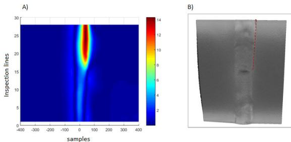
**FIGURE 3:** A) C-SCAN OF THE FATIGUE CRACK; B) 3D CT IMAGE OF THE SAMPLE.
