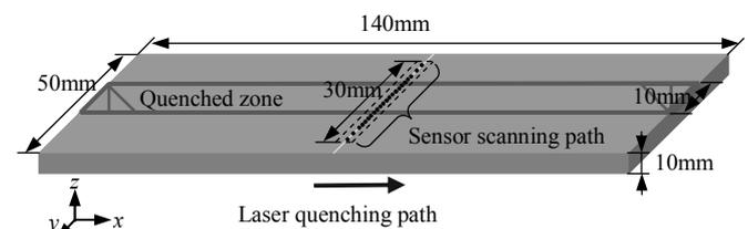
FIGURE 1: THE SIZE OF LASER QUENCHING SAMPLE
