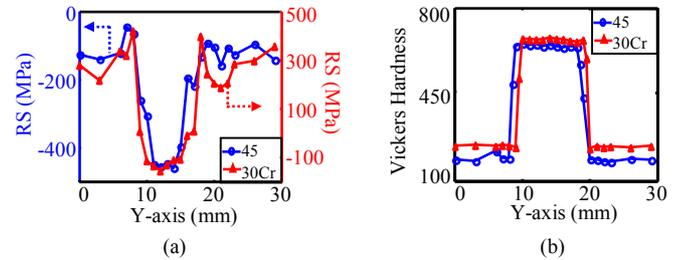
**FIGURE 3:** TEST MEASURED RESULTS OF RESIDUAL STRESS AND HARDNESS ON THE SPECIMEN SURFACE
