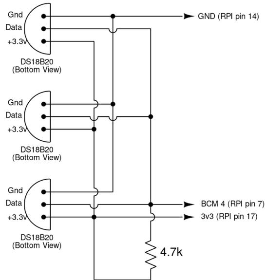
**Fig. 2 DS18B20 1-Wire Circuit**
