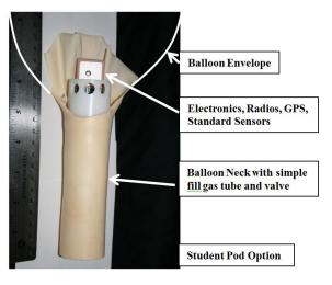
Fig. 3 The EyeStar- Mini module
